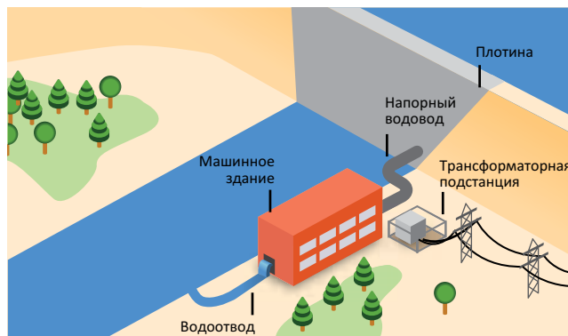
Рис. 7.9. Стандартная резервуарная гидроэлектростанция
