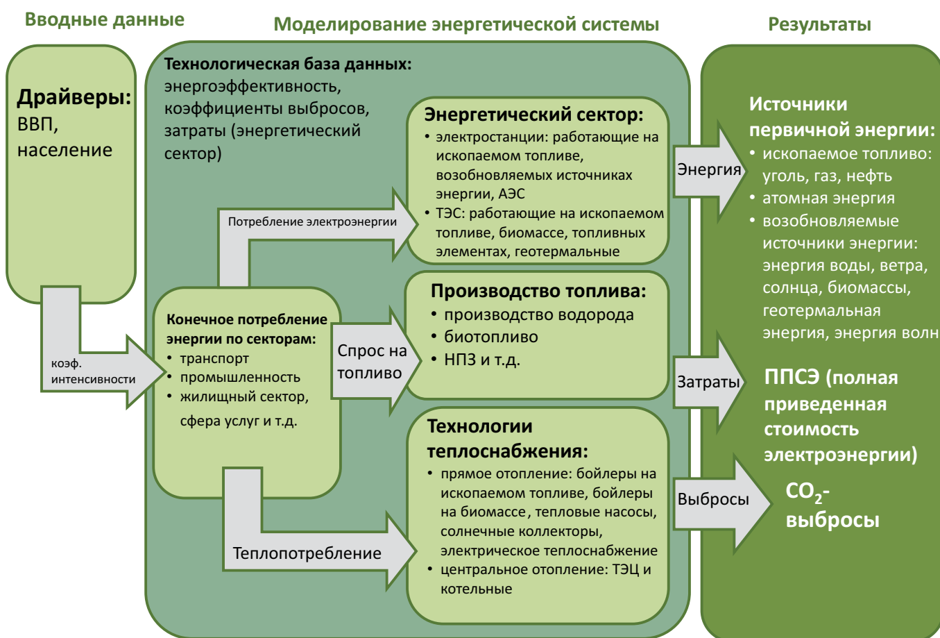
Рис. 5.1. Обзор структуры модели Mesap/PlaNet
