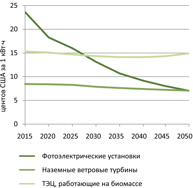
Рис. 5.2. Прогнозируемое изменение стоимости производства электроэнергии при помощи генерирующих мощностей на ВИЭ
